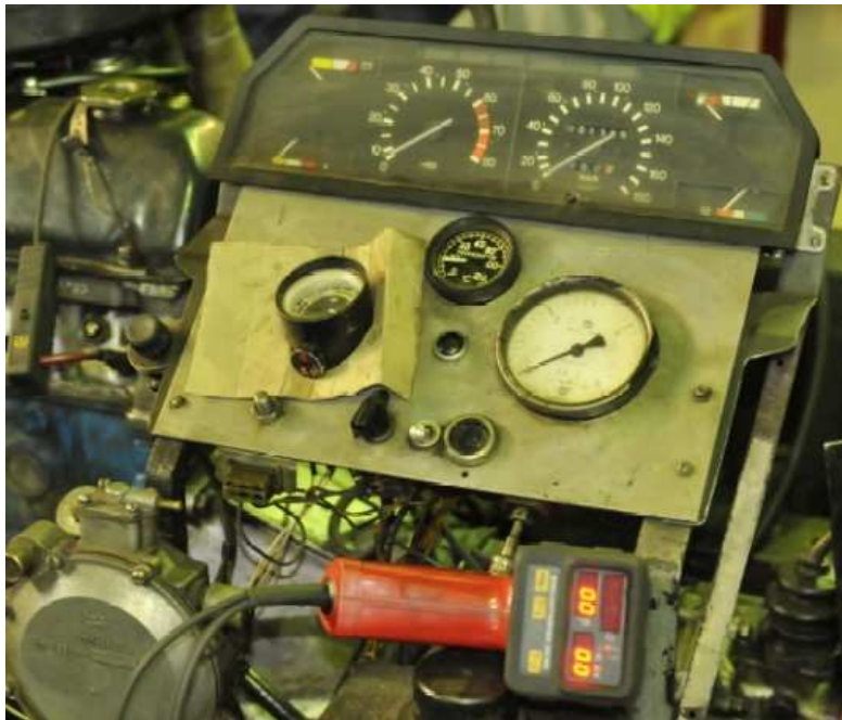
2. attēls. Motora stenda mērinstrumenti un stroboskops
