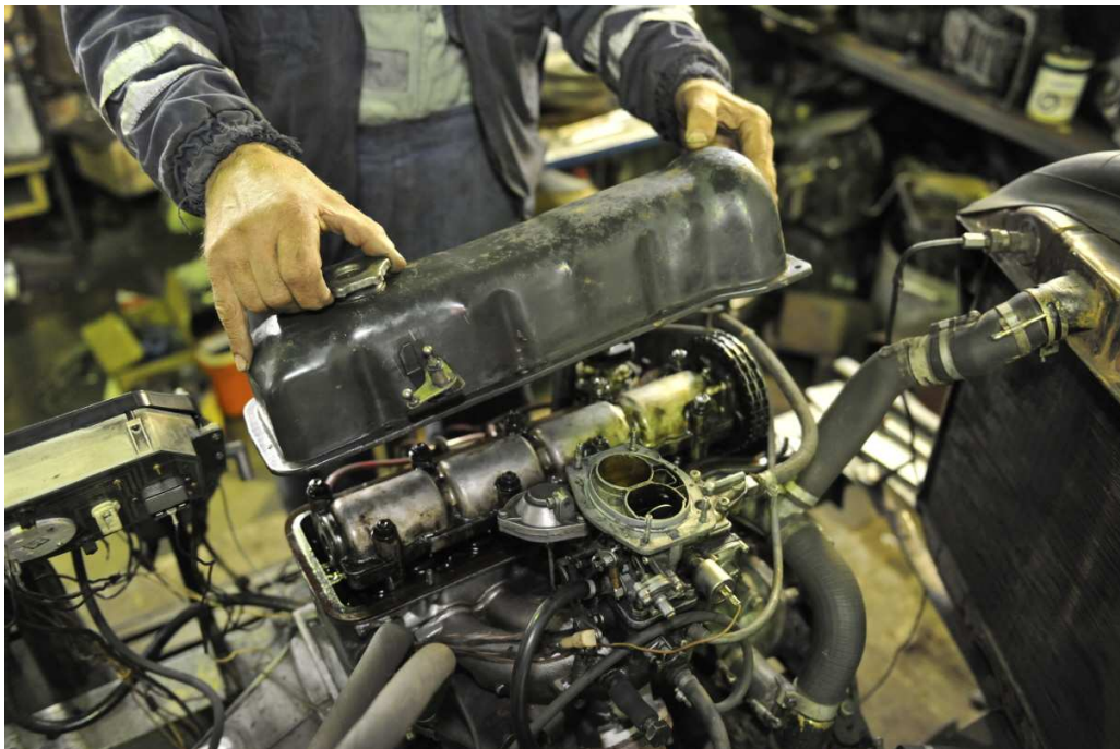
5. attēls. Motora izjaušanas process (vārstu vāka noņemšana)
