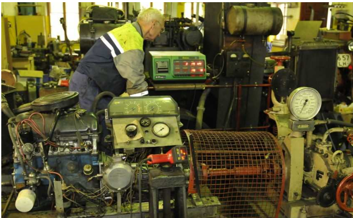
1. attēls. Motora stenda kopskats (motors, mērinstrumenti, hidrauliskā motora bremze), eksperimentālo mērījumu veikšanas process
